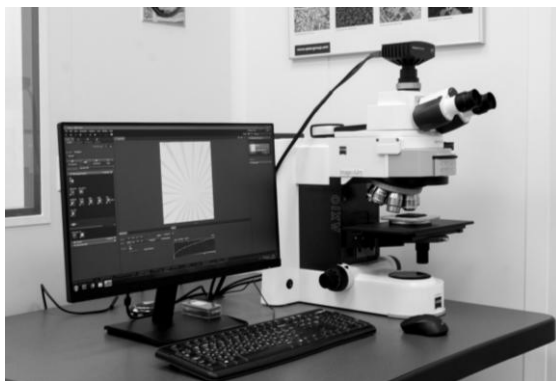
Универсальный исследовательский цифровой микроскоп для исследования в отраженном свете Axio Imager A2m Carl Zeiss. Методы исследования светлое поле, темное поле, поляризационный контраст, дифференциально-интерференционный контраст
